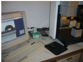
Abbildung 2. Ein Kontaktwinkel-Goniometer mit digitaler Messfähigkeit. (Fotos: iNANO, Universität Aarhus, Creative Commons Attribution ShareAlike 3.0)
