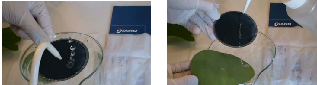
Abbildung 9. Bilder aus dem NANOYOU Video 4-„Lotuseffekt-Teil 2“, das die Benetzungseigenschaften eines Stückes porösen Siliciums (links) im Vergleich zu einem echten Lotusblatt (rechts) zeigt. (Bilder: iNANO, Universität Aarhus, Creative Commons Attribution ShareAlike 3.0)
