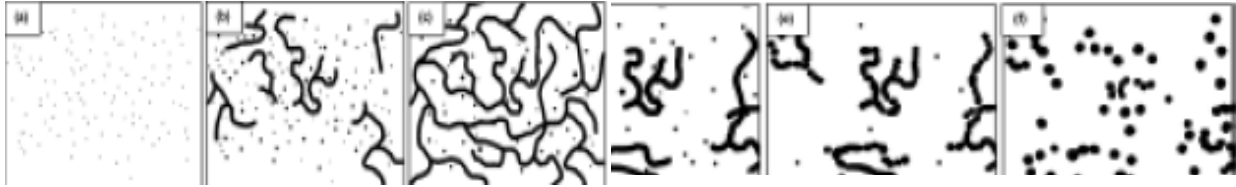
Bild 7: Darstellung der Selbstorganisation von Nanopartikeln: (links) Wachstumsmechanismen von Goldnanodrähten, die zunächst aggregiert sind und dann zu Nanopartikeln zusammengebrochen sind (rechts). (Bildreferenz: Nachdruck mit Erlaubnis von Pong et al., J. Phys. Chem. C 2007, 111, 6281-7. Copyright 2003 American Chemical Society.)
